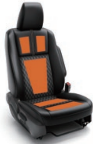
オレンジは、ヒーター加温箇所
