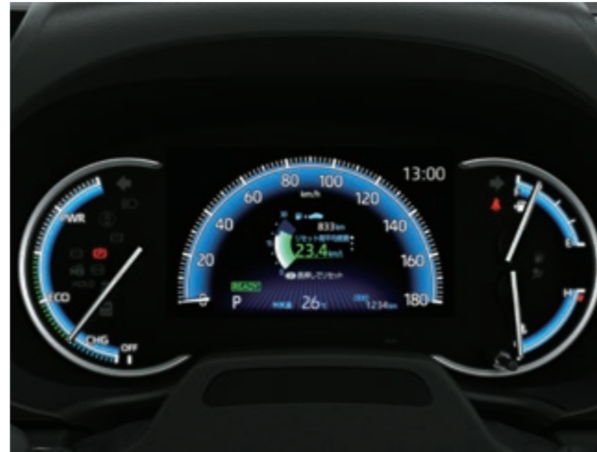
オプティロンメーター+7.0 インチTFT カラーマルチインフォメーションディスプレイ [S-Z、Zに標準装備（写真はハイブリッド車）]
