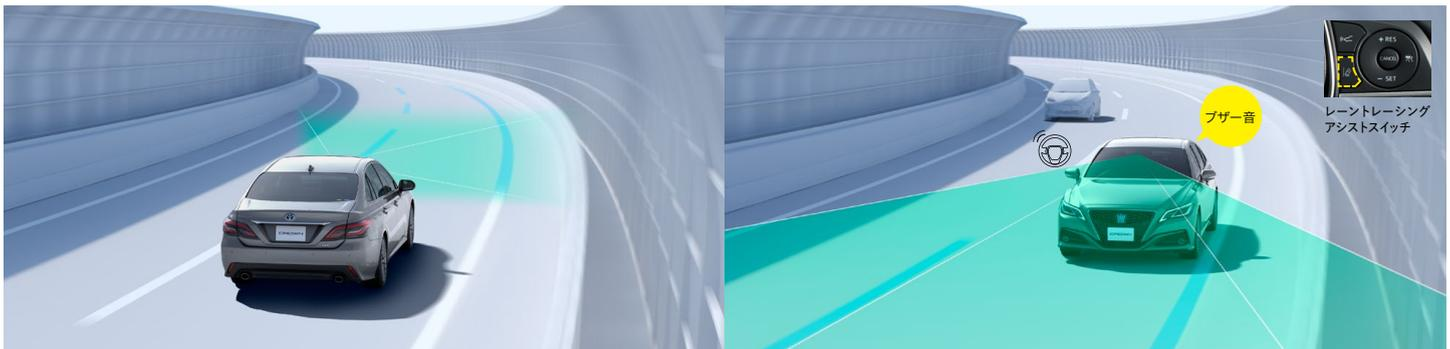
車線の中央を走行するために必要なステアリング操作の一部を支援。渋滞時など白線(黄線)が見えにくい、または見えない場合も、先行車を追従してステアリング操作を支援します。
