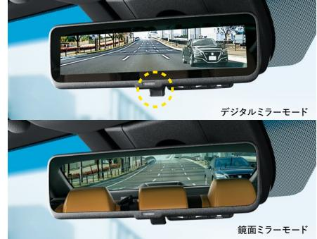
車両後方カメラの映像を表示。
