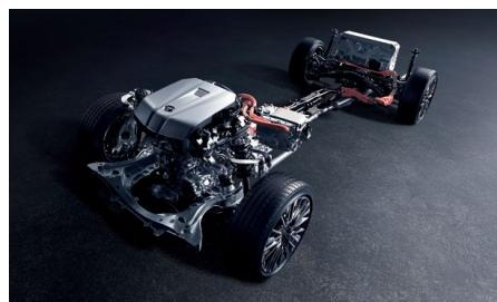
3.5L V6 ENGINE 8GR-FXS × MOTOR・2WD
