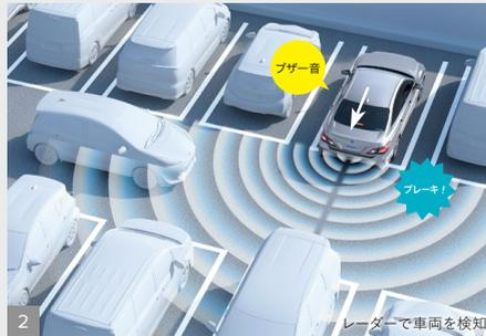
2 後退時、接近してくる車両に対して自動(被害軽減)ブレーキが作動。
