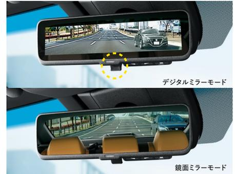
車両後方カメラの映像を表示。
