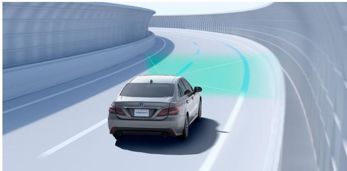
車線の中央を走行するために必要なステアリング操作の一部を支援。渋滞時など白線（黄線）が見えにくい、または見えない場合も、先行車を追従してステアリング操作を支援します。
