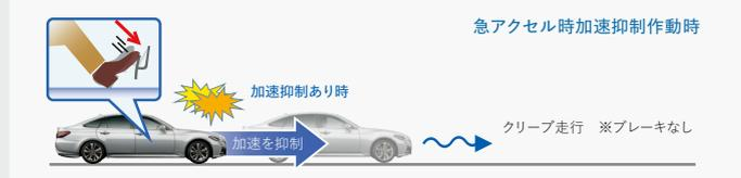
■ブレーキを制御するシステムではありません。■自車車速約30km/h以下で作動します。■前進および後退時に作動します。■アクセルを強く踏み込むような運転をした時に、意図せずシステムが作動することがあります。■プラスサポートで運転中でも、右左折時や車線変更時、一時停止位置や信号待ちからの発進時、急な坂道での発進や加速時には、通常どおり加速できます。ただし、方向指示レバーを操作しないで右左折や車線変更をしたり、ブレーキを踏まない状態(ブレーキホールドでの停車中含む)から発進するとシステムが作動することがあります。その場合でも、一度アクセルを離してゆっくり踏みなおすと加速が可能です。■プラスサポート用スマートキーと標準スマートキーを同時に携帯せず、目的にあった1種類のキーのみを携帯してください。両方のキーが近くにあると、プラスサポート用スマートキーを判定できず、プラスサポートにならない可能性があります。また始動時はメーター等でモードの表示を必ずご確認ください。
