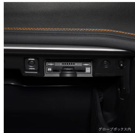
高速道路上に設置されたITSスポットと双方通信を図り、交通情報を提供。
