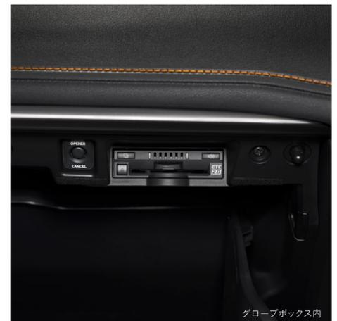
高速道路上に設置されたITSスポットと双方向通信を図り、交通情報を提供。
