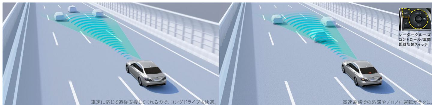
ミリ波レーダーと単眼カメラで先行車を認識し、車速に応じた車間距離を保ちながら追従走行を支援します。
