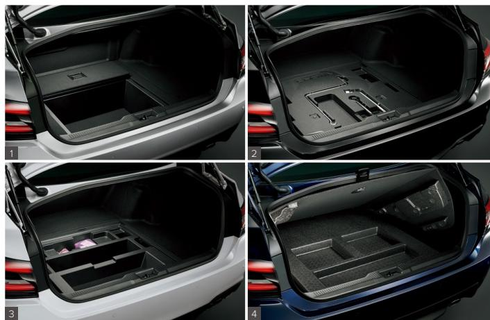
1 ラゲージボックス(折りたたみ式ラゲージボード付) [3.5Lハイブリッド車]
