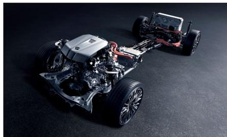
3.5L V6 ENGINE 8GR-FXS × MOTOR・2WD
