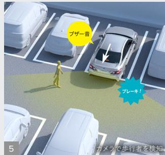
5 後退時、接近する歩行者に対しても自動(被害軽減)ブレーキが作動。
