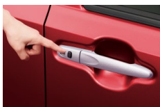
スイッチ操作でドアの施錠・解錠
