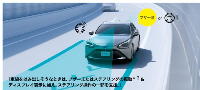
[車線をはみ出しそうなときは、ブザーまたはステアリングの振動\*3 & ディスプレイ表示に加え、ステアリング操作の一部を支援。]
