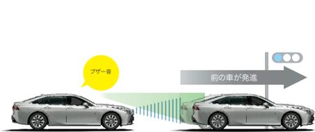
■ TMN: Traffic Movement Notification ■シフトポジションが「P」「R」以外でブレーキペダルを踏んで停車している時に作動します。シフトポジションが「N」の時、またはレーダークルーズコントロール(全車速追従機能付)機能で自車が停止した場合、さらにシフトポジションが「D」の時にブレーキホールドを使用した場合は、ブレーキペダルを踏んでいなくても作動します。 ■先行車が約4m以上進んでも自車が止まったままだとシステムが判断した場合に作動します。なお、機能のON/OFFおよび通知タイミングの変更が可能です。詳しくは取扱書をご覧ください。
