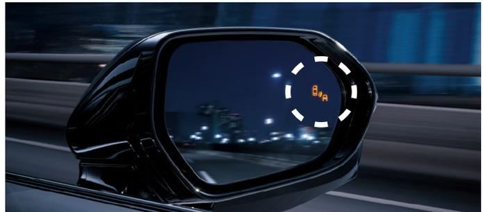
■ BSM: Blind Spot Monitor ■検知対象の目安となる大きさは、小型の二輪車より大きな車両となります。一部の特殊な道路状況等では、静止物に対してもインジケーターが点灯する場合があります。 ■天候状態、道路状況、および車両状態によっては、ご使用にならない場合があります。 ■ブラインドスポットモニターは、車線変更時の後方確認をアシストするシステムです。実際の車線変更時にはドライバー自ら周囲の安全状況を直接確認する必要があります。
