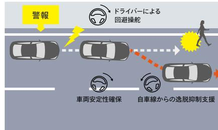
ドライバーによる回避操舵をきっかけに操舵と車線逸脱抑制をサポート。
