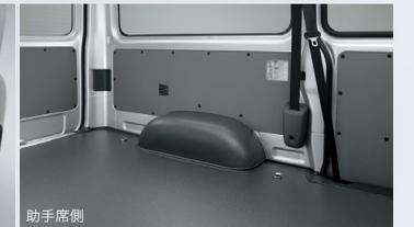
**D**成形フルトリム(収納BOX付) ※Type IIのみ
