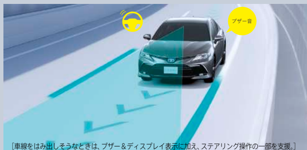
【車線をはみ出しそうなどきは、ブザー&ディスプレイ表示に加え、ステアリング操作の一部を支援。】
