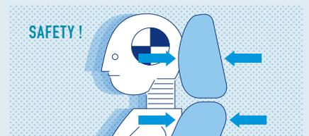
後方から衝突された際に、背中がシートに沈み込み、頭と背中を同時に支えて頸部への衝撃を緩和する構造をもったWILコンセプトシートを採用しています。
