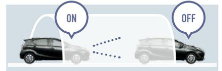
車外の明るさに応じてヘッドランプを自動的に点灯・消灯。夕暮れ時やトンネルの続く山道などで役立ちます。ハイブリッドシステムOFF後、ドアを開けると自動消灯するので、ライトの消し忘れも防止できます。
