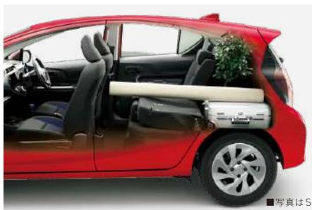
6:4分割可倒式リヤシート/片側倒し状態
