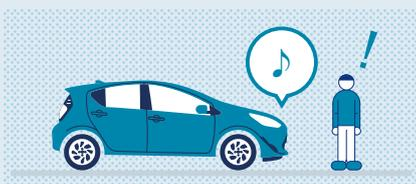
発進から車速約25km/hまでのEV走行中、または後退時に自動で発音。歩行者に音で接近を伝えます。
