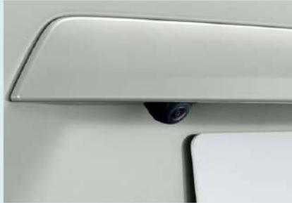
販売店装着オプションのナビゲーションシステムに対応するバックカメラを設定。クルマの後ろの様子をナビ画面に表示するので、車庫入れなどの後退時に役立ちます。
