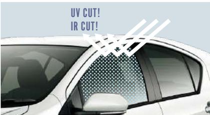
フロントドアガラスは日焼けの原因となる紫外線(UV)を約99%カット\*1。紫外線の強い季節や時間帯でも、気軽にドライブを楽しめます。また、日射しによる暑さのもとである赤外線をカットするIRカット機能付もご用意しています。
