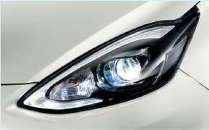
1灯でハイビームとロービームを切り替えられるBi-Beam LEDヘッドランプを設定。前方を明るく照射しながら、省電力に寄与します。先行車・対向車への眩惑防止に配慮し、車両姿勢の変化に応じて照射軸を一定に保つオートレベリング機能付です。
