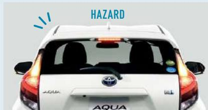
急ブレーキをかけると、ハザードランプが自動的に点滅。後続車に注意を促し、追突される可能性の低減に寄与します。
