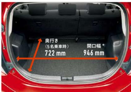
ハイブリッドバッテリーをリヤシート下に配置することで、ゆとりのラゲージスペースを確保。荷物を出し入れする高さの開口幅を大きくするなど、使い勝手にも配慮しました。
