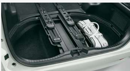
デッキボード取り外し時
