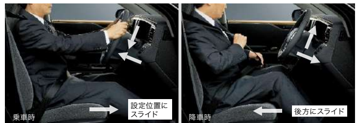
プリセットドライビングポジションシステム(シート[運転席・助手席]・ステアリング・ドアミラー)
