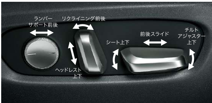
運転席10ウェイパワーシート(前後スライド・リクライニング・シート上下・チルトアジャスター・ヘッドレスト上下調整・メモリー機能付)+パワーランバーサポート
