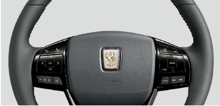
本革巻きヒーター付ステアリングホイール/ステアリングスイッチ(オーディオ・マルチインフォメーションディスプレイ・音声認識・ハンズフリー・レーダークルーズコントロール・レーンディパーチャーアラート)
