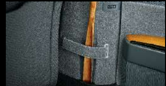
靴べらし（左右センターピラー下部）
