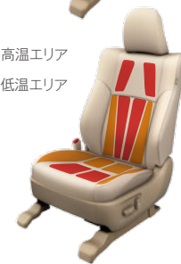
シートベンチレーション&快適温熱シートスイッチ (写真は快適温熱シート作動状態)
