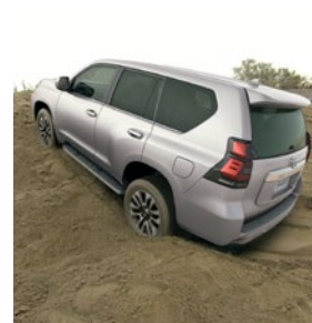
クロールコントロールシステム作動イメージ(スタック状態からの後退脱出)
