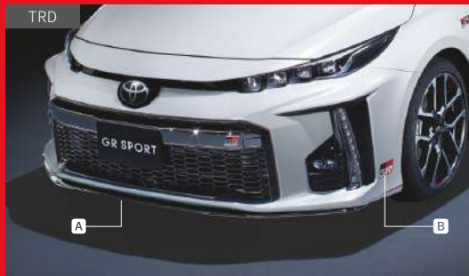
A GRフロントアンダースポILER 49,500円(消費税抜き45,000円) (1.5H)(VRA1) フロントバンパー下部に装着するスポイラーです。 色:ツヤありブラック 材質:樹脂(PPE) 全長:オリジナルより約20mmプラス 地上高:オリジナルより約20mmダウン
