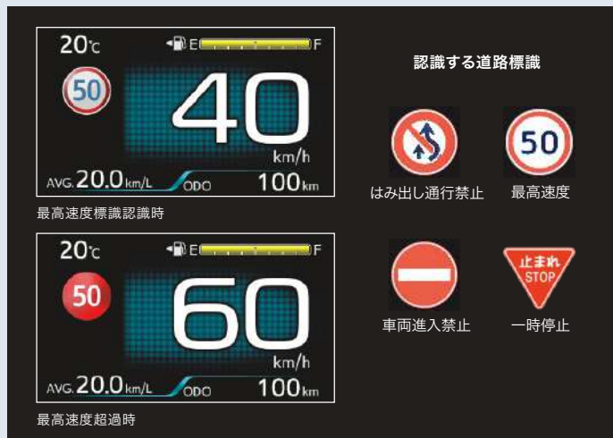
カメラで道路標識を認識しディスプレイに表示。
