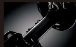
専用チューニングサスペンション (フロント約20mmダウン・リヤ 約25mmダウン)
