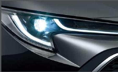
Bi-Beam LEDヘッドランプ+LEDターンランプ
