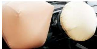
\*9. SRS[乗員保護補助装置]:Supplemental Restraint System ■写真は機能説明のためにSRSエアバッグが作動した状態を再現したものです。 ■SRSエアバッグは、シートベルトを補助する装置です。必ずシートベルトをご着用ください。 ■SRSエアバッグは、衝突の条件によっては作動しない場合があります。 ■チャイルドシート等を助手席に装着するときは、後ろ向きにしないなど、ご注意ください。必ず取扱書をご覧ください。
