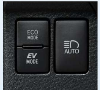
■設定した各モードスイッチをもう一度押せば、「通常走行モード」に戻ります。
