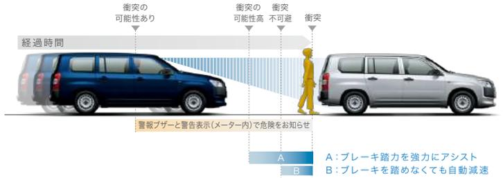
■警報は対車両の場合は自車速度約15km/h～140km/h\*1、対歩行者(昼)の場合は自車速度約15km/h～65km/h、自動(被害軽減)ブレーキは対車両の場合は自車速度約10km/h～80km/h、対歩行者(昼)の場合は自車速度約10km/h～65km/hで作動します。また、道路状況、車両状態、天候状態およびドライバーの操作状態等によっては、作動しない場合があります。詳しくは取扱書をご覧ください。■プリクラッシュセーフティはあくまで運転補助機能です。本機能を過信せず、必ずドライバーが責任を持って運転してください。■数値は社内測定値。
