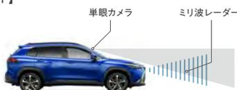
**POINT 2** 2種類のセンサーで高い認識性能と信頼性を両立。
