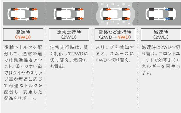
\*1. エンジンとモーターにより、動力性能として発揮できる出力。社内算定値。\*2. E-Fourは、機械式4WDとは機構および性能が異なります。さまざまな走行状態に応じてFF(前輪駆動)走行状態から4WD(4輪駆動)走行状態まで自動的に制御し、安定した操縦性・走行の安定性および燃費の向上に寄与するものです。■路面の状況、勾配、高速等の走行環境によってはガソリン4WD車に比べ、十分な駆動力が得られない場合があります。
