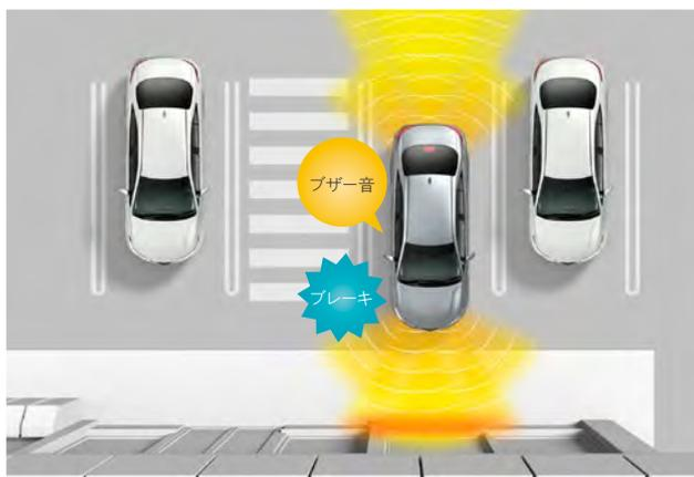
アクセルの踏み間違いや踏みすぎなどで起こる衝突を緩和し、被害の軽減に寄与するシステム。車庫入れなどの運転時、静止物の接近を表示とブザーでお知らせします。前後進行方向にある壁などの静止物を検知している場合、発進時にエンジン出力/ハイブリッドシステム出力を抑制し、さらに距離が縮まると自動(被害軽減)ブレーキが作動します。
