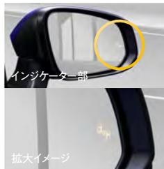
ブラインドスポットモニター[BSM]は隣の車線を走る車両をレーダーで検知。ドアミラーでは確認しにくい後側方エリアに存在する車両に加えて、隣接する車線の最大約60m後方までモニターし、急接近してくる車両も検知します。車両を検知するとドアミラーに搭載されたLEDインジケータが点灯。その際、ウインカーを操作するとLEDインジケータが点滅し、より注意を喚起します。
