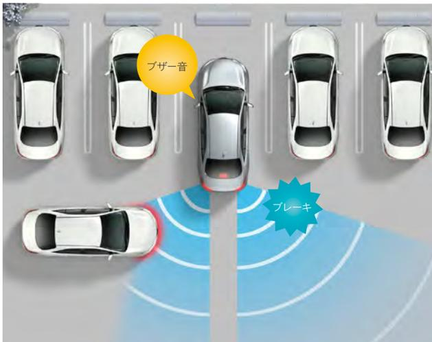
駐車場から後退する際に、自車の左右後方から接近してくる車両をレーダーで検知。ドアミラー内のインジケータ点滅とブザーによりドライバーに注意を喚起します。衝突の危険性がある場合は自動的にブレーキ制御を行うことで接近車両との衝突被害軽減を支援します。
