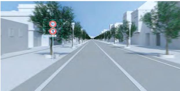
カメラで道路標識を認識しマルチインフォメーションディスプレイに表示。
