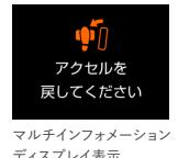
シフト操作時における急発進・急加速を抑制し、衝突時の被害軽減に寄与。たとえば、後退時に衝突して慌てたドライバーが、アクセルを踏み込んだままシフトを「R」から「D」へ変更した際、表示で注意を促し、ハイブリッドシステム出力を抑えます。また、後退時、必要以上にアクセルを踏み込んで速度が上がりすぎると防ぐために、ハイブリッドシステム出力を抑えます。
