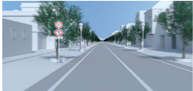
単眼カメラで道路標識を認識しマルチインフォメーションディスプレイに表示します。
