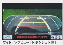
■カメラが映し出す範囲は限られており、実際より遠く見える場合があります。映像を過信せず、必ず車両周辺の安全を直接確認しながら運転してください。
