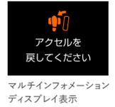
シフト操作時における急発進・急加速を抑制し、衝突時の被害軽減に寄与。たとえば、後退時に衝突して慌てたドライバーが、アクセルを踏み込んだままシフトを「R」から「D」へ変更した際、表示で注意を促し、ハイブリッドシステム出力を抑えます。また、後退時、必要以上にアクセルを踏み込んで速度が上がりすぎるのを防ぐために、ハイブリッドシステム出力を抑えます。
