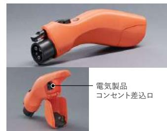
■消費電力の合計が1500W以下の電気製品をご使用ください。ただし、電気製品によっては消費電力の合計が1500W以下の場合でも正常に作動しない場合があります。 ■一部の自治体では、駐車または停車中にエンジンを始動させた場合、アイドリングストップに関する条例にふれるおそれがあります。関係する自治体に確認した上で、適切にご使用ください。 ■工場出荷時の給電周波数は50Hzになっています。60Hzに変更する場合は販売店にご相談ください。
