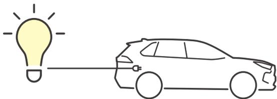
■EV給電モード EV給電モード時に1500Wの最大出力で使い続けた場合、バッテリー満充電状態から約7時間、一般家庭が日常使用する電気量:1日当たり10kWh(1時間当たり400W)では約20時間の電力を供給可能。
