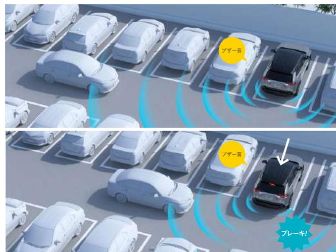
駐車場から後退する際に、自車の左右後方から接近してくる車両をレーダーで検知。ドアミラー内のインジケータ点滅とブザーによりドライバーに注意を喚起します。衝突の危険性がある場合は自動的にブレーキ制御を行うことで接近車両との衝突被害軽減を支援します。
