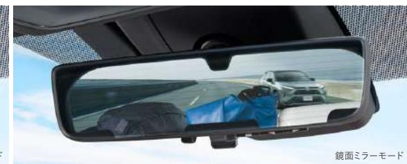
車両後方カメラの映像を、インナーミラー内の9.6インチ大画面ディスプレイに高解像度で表示。切替レバーを操作することで、鏡面ミラーモードからデジタルミラーモードに切り替えることができます。ヘッドレストや荷物などで視界をさえぎられずに、円滑な後方確認をサポートします。
