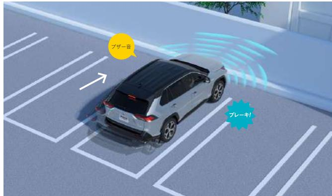
アクセルの踏み間違いや踏みすぎなどで起こる衝突を緩和し、被害の軽減に寄与するシステムです。車庫入れなどの運転時、静止物の接近を表示とブザーでお知らせします。前後進行方向にある壁などの静止物を検知している場合、発進時にハイブリッドシステム出力を抑制し、さらに距離が縮まると衝突被害軽減ブレーキをかけます。
