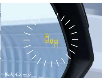
隣の車線を走る車両をレーダーで検知。ドアミラーでは確認しにくい、後側方エリアに存在する車両に加えて、隣接する車線の最大約60m後方までモニターし、急接近してくる車両も検知します。車両を検知すると、ドアミラーに搭載されたLEDインジケーターが点灯。その際、ウインカーを操作するとLEDインジケーターが点滅し、より注意を喚起します。
