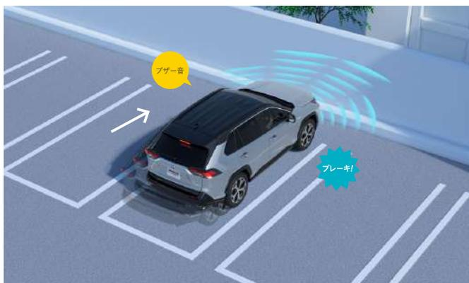
アクセルの踏み間違いや踏みすぎなどで起こる衝突を緩和し、被害の軽減に寄与するシステムです。車庫入れなどの運転時、静止物の接近を表示とブザーでお知らせします。前後進行方向にある壁などの静止物を検知している場合、発進時にハイブリッドシステム出力を抑制し、さらに距離が縮まると衝突被害軽減ブレーキをかけます。
