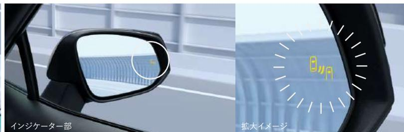
隣の車線を走る車両をレーダーで検知。ドアミラーでは確認しにくい、後側方エリアに存在する車両に加えて、隣接する車線の最大約60m後方までモニターし、急接近してくる車両も検知します。車両を検知すると、ドアミラーに搭載されたLEDインジケータが点灯。その際、ウインカーを操作するとLEDインジケータが点滅し、より注意を喚起します。
