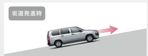
もちろん、坂道発進もスムーズに。 坂道でアイドリングストップ状態から再始動する時は、坂道発進補助機能が車両の後退を抑制します。
