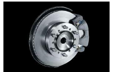
■ ベンチレーテッドディスクブレーキ (フロント)
