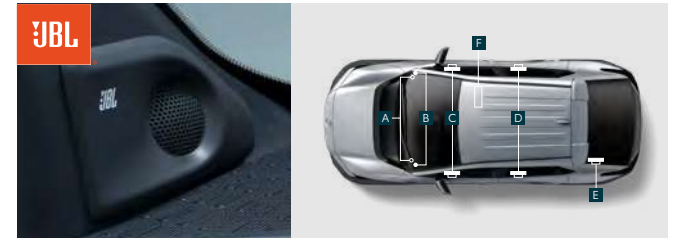
A 9cm スコーカー B 2.5cm ホーンツイーター C 8×9inch ウーハー D 15cm フルレンジスピーカー E 22.4cm サブウーハー F 専用アンプ
