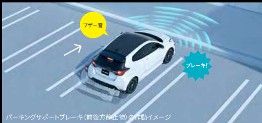
パーキングサポートブレーキ(前後方静止物)の作動イメージ
