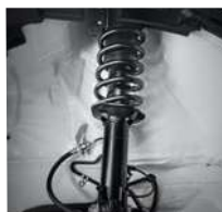
マクファーソンストラット式 フロントコイルサスペンション
