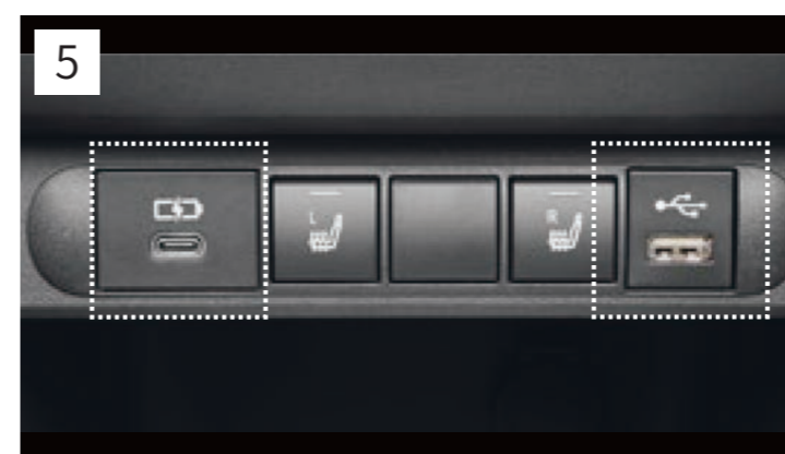
左：充電用USB端子 (Type-C) *1 右：通信用USB端子*1
