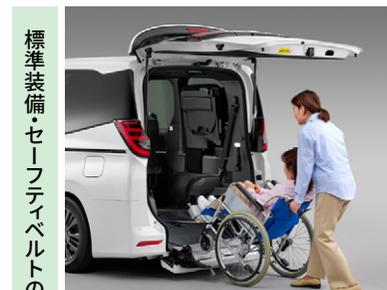
④ 車いすの前輪をショートスロープの上段に乗せ、車いすの後輪をスロープ下段に押し当てながら持ち上げ、車内に乗り入れます。
