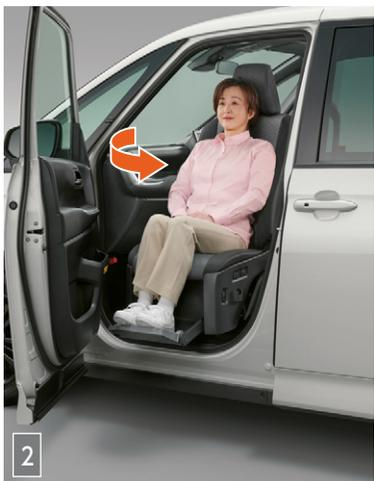
2 シートは外側へ回転後、車外へスライドダウンしながら座面の前傾が始まります。
