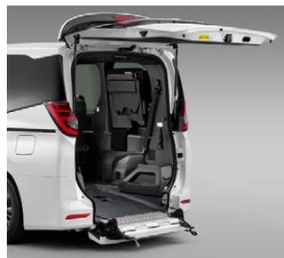
② ロック解除レバーを引き上げてテールゲートを開き、展開ベルトを引いて2段折れになっているパネルを展開します
