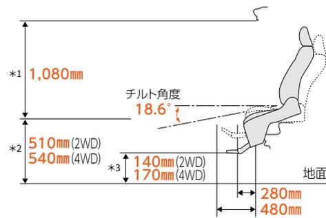
\*1.チルト後の座面中央部高さからドア開口部上端までの寸法です。
