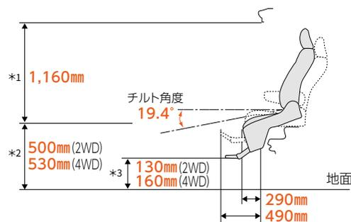
\*1.チルト後の座面中央部高さからドア開口部上端までの寸法です。
