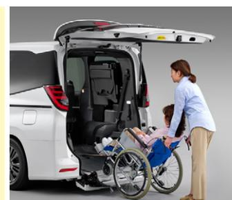
④ 車いすの前輪をショートスロープの上段に乗せ、車いすの後輪をスロープ下段に押し当てます。電動ウインチの「上」を押し続けると、車内に引き上げられます。また、「上」を2回連続で押すと自動モードが開始され、リモコンから手を離れた状態で、車いすの乗り入れをアシストすることができます。リモコンはホルダーで車いすのハンドルなどに装着可能です。
