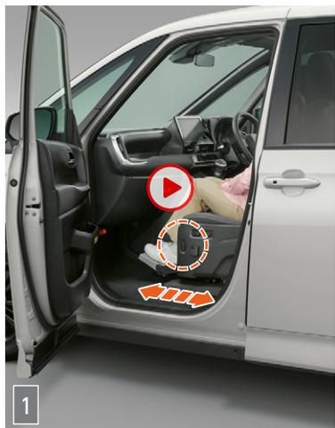
1 助手席ドアを全開にして、ワイヤレスリモコンスイッチ(またはシート昇降スイッチ)を押し続けると、回転開始位置までシートがスライドして、背もたれ角度を自動的に調整します。
