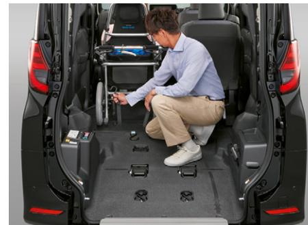
⑥ 車いすのブレーキをかけます。その後、後側の車いす固定装置(電動)のフックを取り出し、車いすの後部フレーム(左右2か所)に掛け、車いす固定スイッチを押して車いすを固定します。
