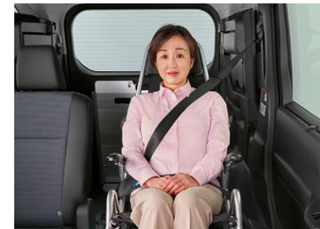
⑦ 車いす用シートベルトを着用します。スロープを格納し、バックドアを閉めると自動的に車高復帰します(運動モード時)。
