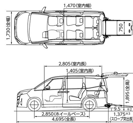
※1 バックドア開放時、地上からのバックドアの高さは標準車と同じです。 ※2 車高降下時の地上線です。 ※3 車高降下時の寸法です。
