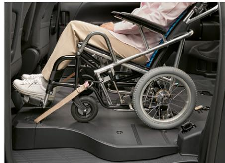
⑤ フロアのガイドラインを目安にセカンド席まで進み、車いすの後輪中央を床面の停止線に合わせ停止します。セーフティベルトにより、車いすの前側が固定されます。
