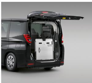
①バックドアを開けると自動的に車高が下がり、セーフティベルトがフリーモードになります(連動モード時)。(車高は下がきると自動停止します)
