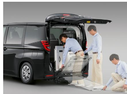
②スロープが前倒れ状態になっている場合は垂直に起こします。スロープを支えながら、ロック解除レバーを引き上げてロックを解除し、スロープの取っ手を持って車外へ最後まで引き出します。
