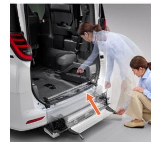
⑤ 車いすを固定し車いす用シートベルトを装着後、テールゲート格納ベルトを車内側に引き上げてショートスロープを格納します。バックドアを閉めると自動的に車高復帰します(運動モード時)。
