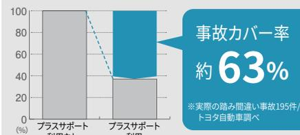
■踏み間違いを検知した時に自車車速約30km/h以下で加速抑制が作動します。(障害物がないシーンでも作動) ■コネクティッドカーのビッグデータをもとに開発し、踏み間違い事故の約63%で作動を期待できます。
