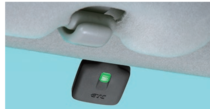
GPS内蔵ETCアンテナ装着例
