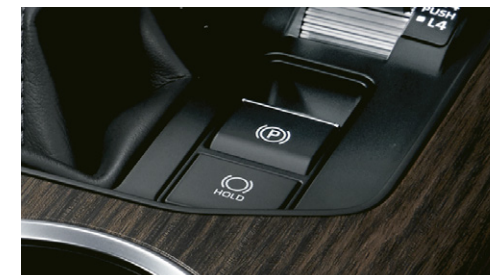
上:電動パーキングブレーキスイッチ
