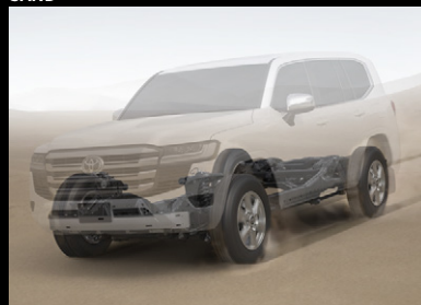
クローラコントロールシステムイメージ(スタック状態からの後退脱出)
