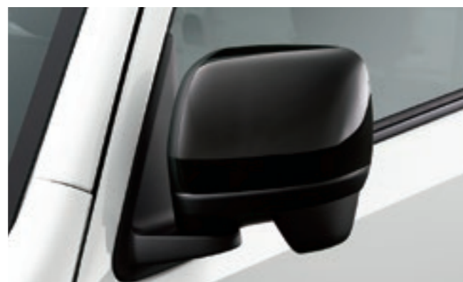
電動格納式ドアミラー カラードドアミラー(ブラック塗装)
