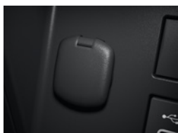
⑬アクセサリースOCKET (DC12V・120W/センターコンソールボックス内側1個)
