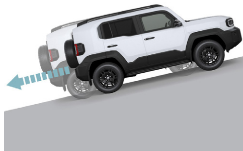
制御なし。車両がずり落ちることがあります。
