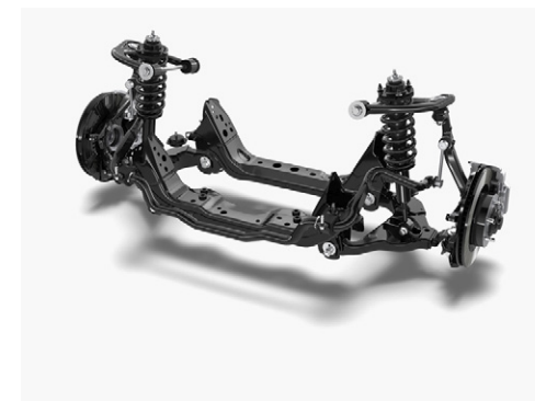
ハイマウント・ダブルウィッシュボーン式フロントサスペンション
