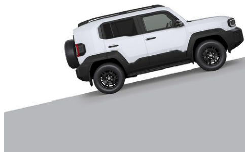
制御あり。発進時にブレーキの制御でずり落ちを緩和します。
