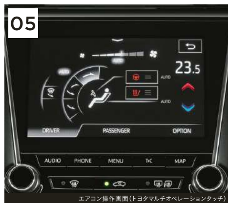
エアコン操作画面(トヨタマルチオペレーションタッチ)
