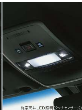
前席天井LED照明(タッチセンサー式)
