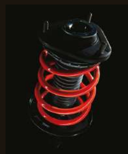
専用チューニングサスペンション (約25mmダウン)
