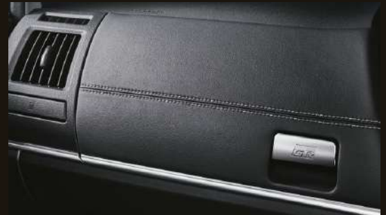
助手席側インストルメントパネル (革シボ調合成皮革+シルバーダブルステッチ+クロームメッキモール) +サイドレジスター(革シボ調+クロームメッキモール)
