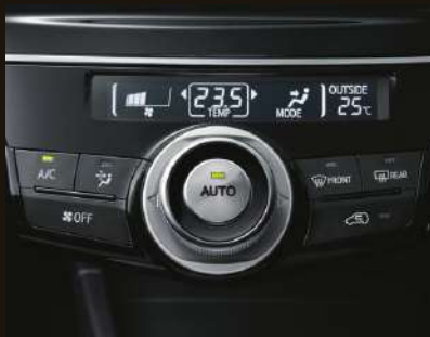
エアコン温度調整ダイヤル (クロームメッキ+スピンドル調加工 +高輝度シルバー塗装)
