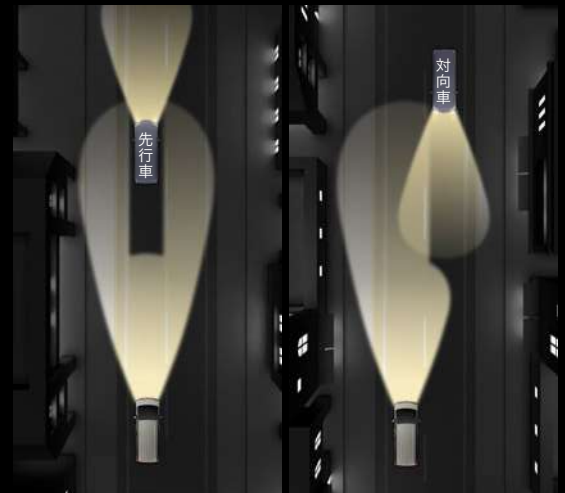
アダプティブハイビームシステム作動イメージ 先行車や対向車のランプ・街路灯などを検出すると、自動でハイビームからロービームまたは遮光範囲可変ビームへ切替え。
