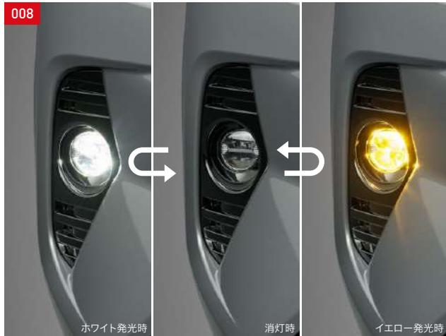
シャープなホワイトの光を照射。ヘッドランプの明るさを補助します。
