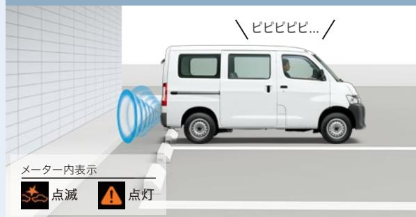
後方約2~約3m先まで壁などの障害物等があることをソナーセンサーが検知している時に、シフトポジションを「後退」にしたままブレーキペダルと間違えて必要以上にアクセルペダルを踏み込んだ場合、急発進を抑制します。
