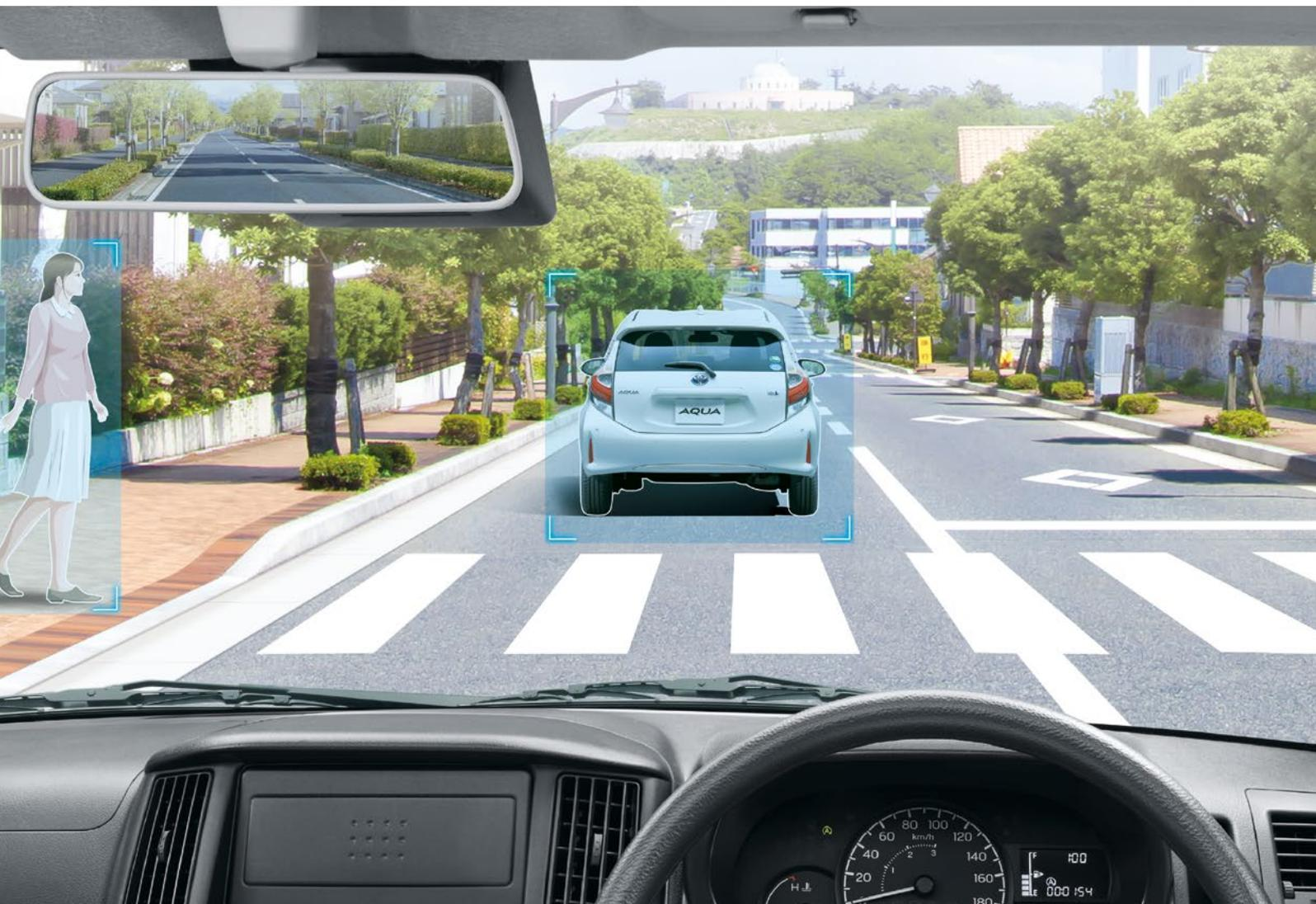
Photo: DX(2WD)。 ■写真はステレオカメラが前方の車両と歩行者を検知しているイメージです。 ■写真は合成です。
