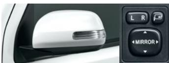
サイドターンランプ付カラードアミラー(電動格納式リモコン)
