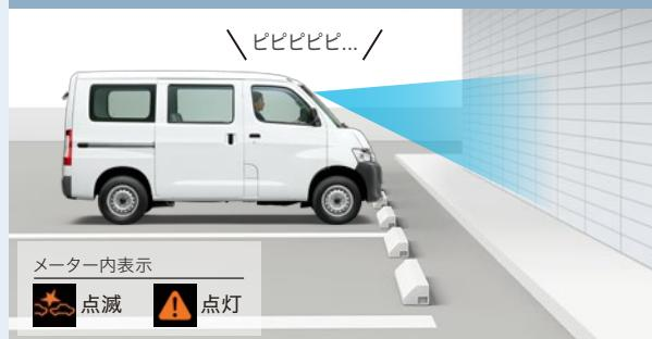
前方約4m以内に障害物等があることをステレオカメラが検知している時に、シフトポジションを「前進」にしたままブレーキペダルと間違えるなどして必要以上にアクセルペダルを踏み込んだ場合、急発進を抑制します。
