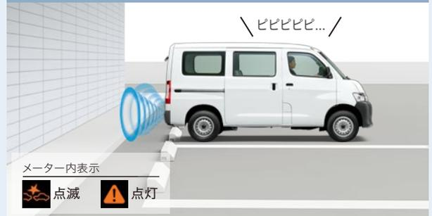
後方約2～約3m先までに壁などの障害物等があることをソナーセンサーが検知している時に、シフトポジションを「後退」にしたままブレーキペダルと間違えて必要以上にアクセルペダルを踏み込んだ場合、急発進を抑制します。
