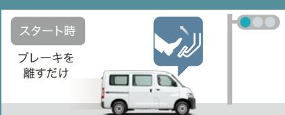
もちろん、坂道発進もスムーズに。坂道でアイドリングストップ状態から再始動する時は、坂道発進補助機能が車両の後退を抑制します。
