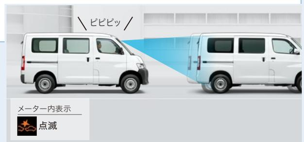
■前方約10m以内の先行車が約3m以上進んでも自車が止まったままだとシステムが判断した場合に作動します。 ■AT車はブレーキペダルを踏んでいる時に作動します(シフトポジションが[P]・[R]の時は作動しません。[N]の時はブレーキペダルを踏んでいなくても作動します)。 ■MT車は[R]以外でブレーキペダルを踏んでいる時に作動します。
