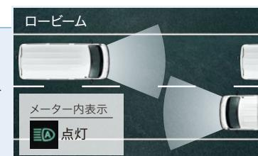
■自車速度約30km/h以上で作動します。 ■ハイビーム・ロービームの切り替え自動制御には状況により限度があります。運転時にはつねに周囲の状況に注意し、状況に応じて手動で切り替えるなど、安全運転を心がけてください。
