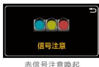
前方の交差点にて赤信号で停止することが予測される時に、ハイブリッドシステムインジケータのエコアクセルガイドのゲージをゼロにすることで、ドライバーが無駄な加速をし続けないう支援します。
