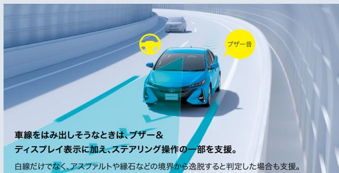
道路上の白線(黄線)を単眼カメラで認識し、車線を逸脱する可能性がある場合、警報ブザーとディスプレイ表示での警告に加え、ステアリング操作の一部を支援します。さらに高速道路や自動車専用道路を走行中、レーダークルーズコントロール(全車速追従機能付)の作動時\*2に、車線維持に必要なステアリング操作をサポートします。
