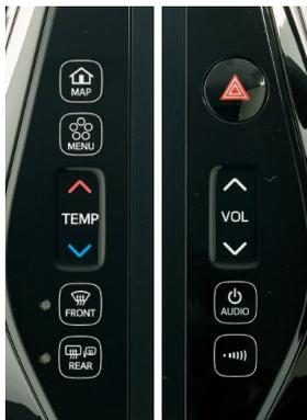
エアコンの温度調整やデフロスタースイッチ、オーディオの音量調整など、操作頻度の高いスイッチはディスプレイの左右に配置し、ドライバーの使いやすさに配慮。こちららも静電式のタッチスイッチ\*4とすることでフラットなパネルを実現しています。
