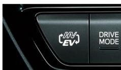
「EV/HVモード切替スイッチ」を長押しすると「バッテリーチャージモード」に切り替わります。
