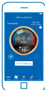
リモートでエアコンの起動・停止ができます。冷暖房の設定やデフロスター(フロント・リヤ)のON/OFF設定が可能です。
