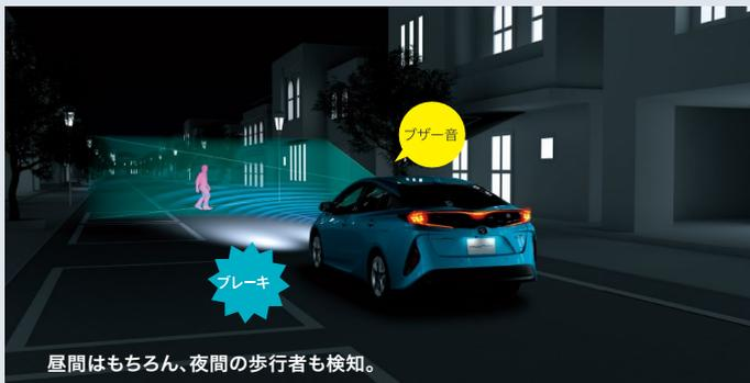
前方の車両や歩行者(昼夜)、自転車運転者(昼)をミリ波レーダーと単眼カメラで検出。警報ブザーとディスプレイ表示で衝突の可能性を知らせ、ブレーキを踏めた場合はプリクラッシュブレーキアシスト、ブレーキを踏めなかった場合はプリクラッシュブレーキを作動させ、衝突回避または被害軽減をサポートします。プリクラッシュブレーキは歩行者や自転車運転者に対しては自車が約10~80km/hの速度域で作動し、たとえば、歩行者との速度差が約40km/hの場合には衝突回避または被害軽減をサポート。また、車両に対しては自車が約10km/h以上で作動。たとえば、停止車両に対し自車の速度が約50km/hの場合は、衝突回避または被害軽減をサポートします。
