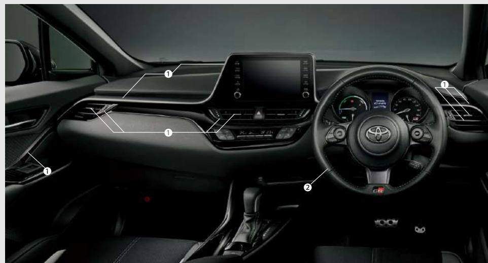
①インストルメントパネル加飾&ドアインナーガーニッシュ (GR専用金属調ダークシルバー塗装) ②GR専用本革巻き小径3本スポークステアリングホイール(シルバーステッチ+ GR エンブレム+スポーク部:ダークシルバー塗装)
