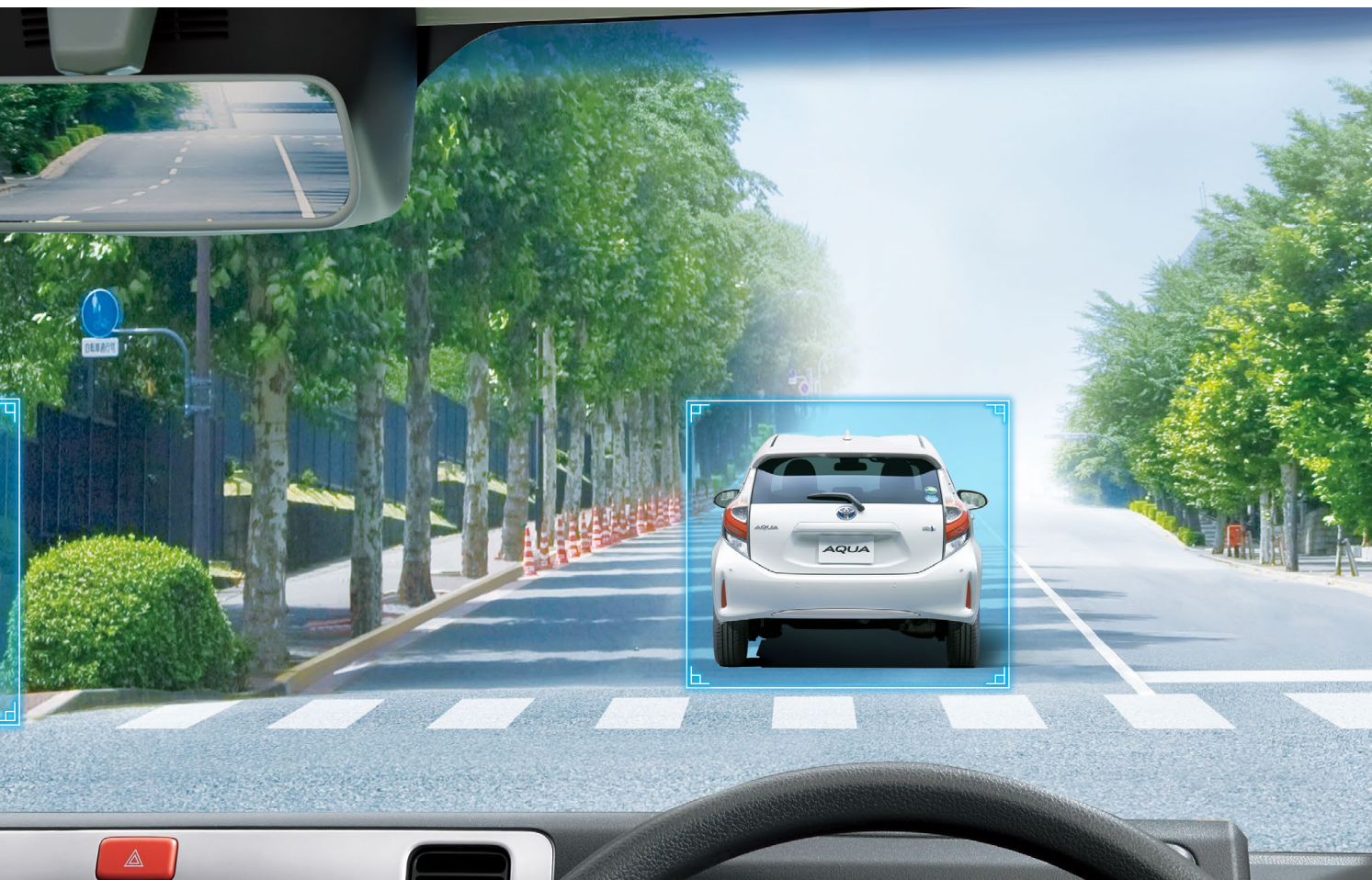
■写真はステレオカメラが前方の車両と歩行者を検知しているイメージです。
