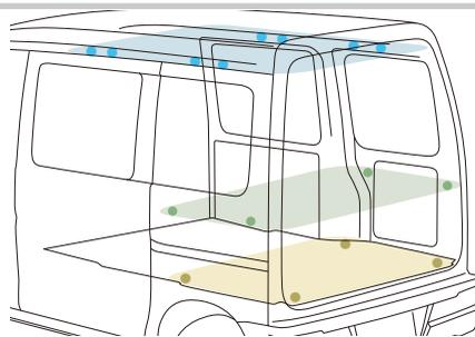
■荷室上部ユースフルナットは通常アシストグリップ・天井トリムに隠れています。後部座席の天井にある4つのユースフルナットは、アシストグリップを取り外すと使用可能となります。
